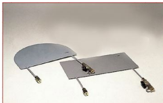
Mynd 4.12: Plötur í plötutjökkunarprófi (Eberhardt, 2004).
